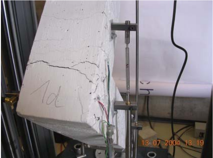
Risse während der Belastung
