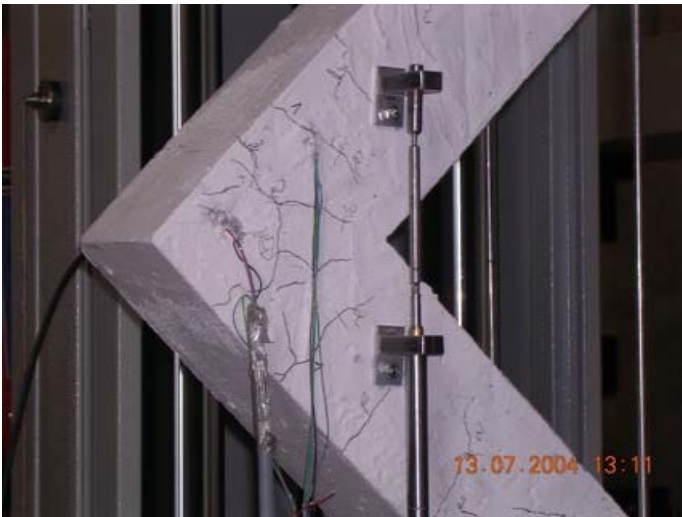
Risse während der Belastung
