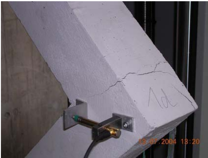
Risse während der Belastung
