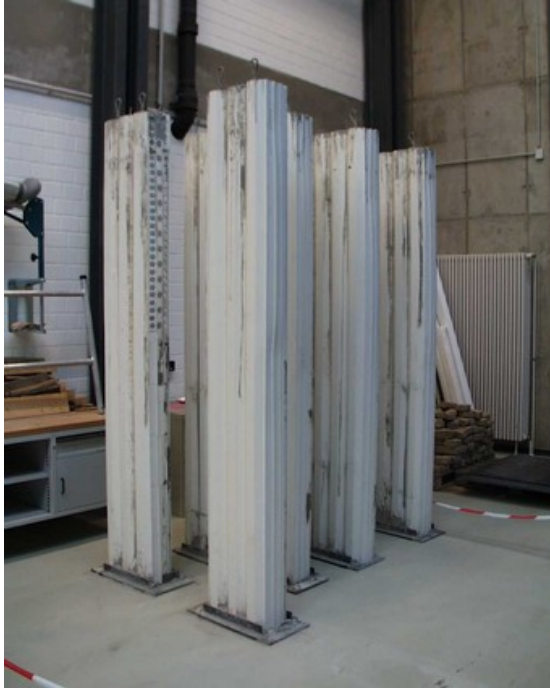
Prüfkörper für Druck und Biegung
