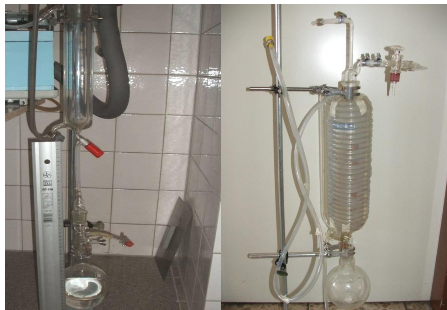
Abb. 2 Vergleich Wasserabscheider links-alt; rechts-modifiziert
