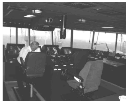
Bild 2: Der Lotse ist auf der Brücke. Sie ist ausgerüstet mit einer NACOS-Anlage (STN-Atlas-Elektronik).
