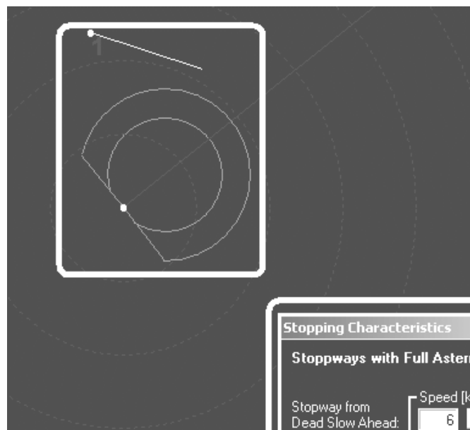
Abbildung 9: Einblendung der Handlungsgrenzen „Nahbereich“ und „Kritische Distanz“ als Entscheidungshilfe beim Fahren unter den Bedingungen der verminderten Sicht
