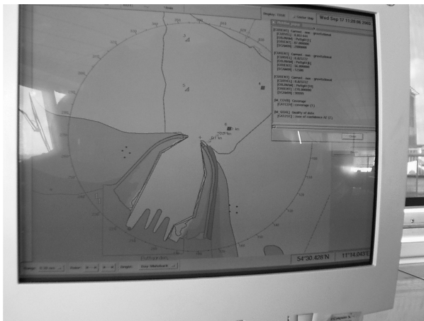
Bild 11: Darstellung der Strömung und des Windes in der ECDIS „Hafeneinfahrt Puttgarden“ am 17.09.03 an Bord des FS „Schleswig-Holstein“ nach Übertragung via AIS.
