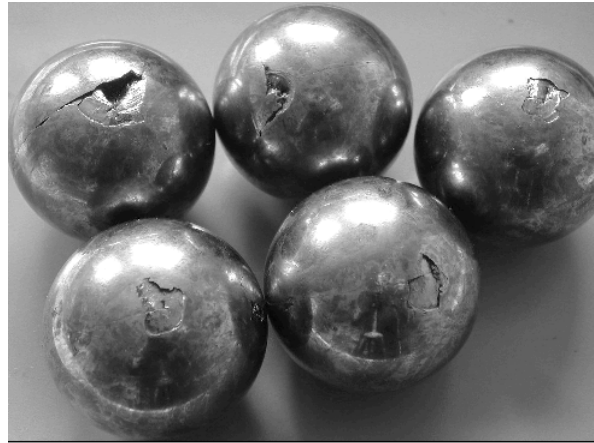
Bild 1.4 Stillstandsmarken am Außenring des Lagers Bild 1.5 Defekte Wälzkörper
