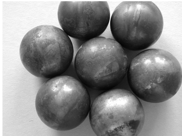
Bild 2.6 Wälzkörper des Lagers
