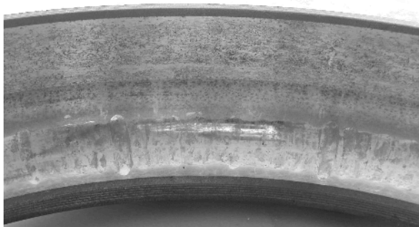
Bild 1.4 Stillstandsmarken am Außenring des Lagers Bild 1.5 Defekte Wälzkörper
