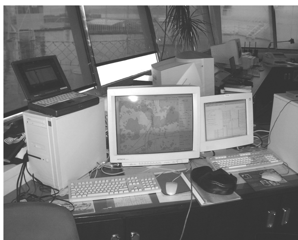
Bild 1: Arbeitsplatz der Arbeitsgruppe auf dem MS „Transeuropa“ mit Host-System und ECDIS-Dopplung.
