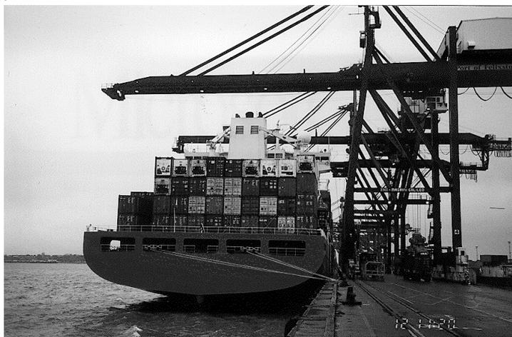
Viele Häfen haben bereits Kräne installiert oder bestellt die Schiffe mit 22 oder sogar 23 Container in der Schiffsbreite abfertigen können. D. h. die Häfen ihrerseits gehen ebenfalls von einer beachtlichen Vergrößerung der zukünftigen Containerschiffe aus. Technisch stellen Kräne mit 60 m outreach kein Problem dar.
