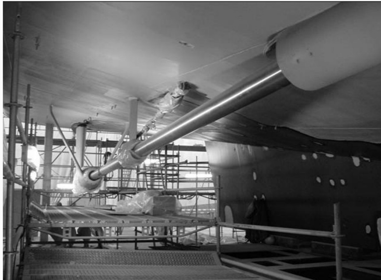
2 Propellerwellen, Länge 18 m, Werkstoff Duplex- Stahl 1.4462
