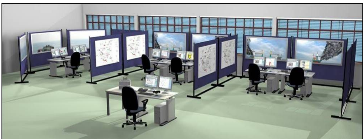
Abb. 9 Konfigurationsbeispiel des SST-Simulators – ein Instruktor- und drei Trainee-Arbeitsplätze
