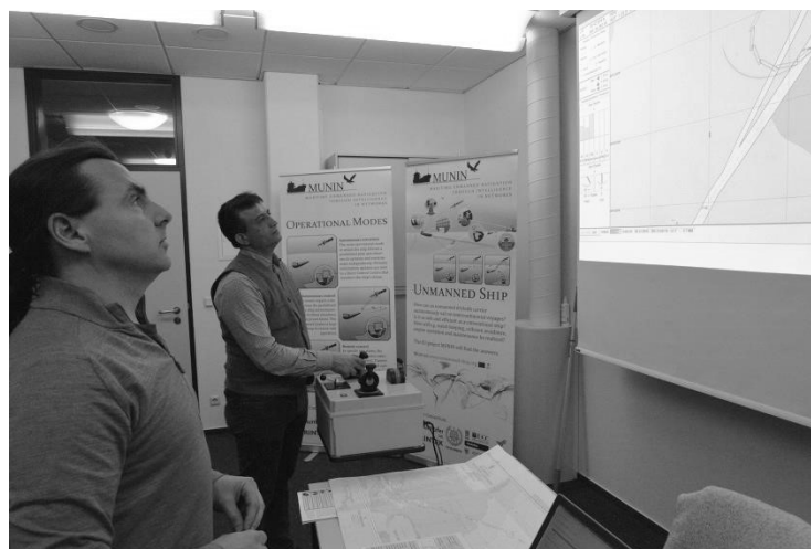
Abbildung 3.6: Manuelles Manövrieren des Schiffes im „Situation Handling Room“ der Landzentrale. Nautiker und Operateur sind gemeinsam involviert – Versuchsaufbau Maritimes Simulationszentrum Warnemünde (MSCW) (ISSIMS)
