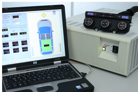
Abbildung 1: HiL Simulator mit angeschlossenem Steuergerät
