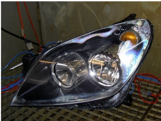
Abbildung 1: Betauungskritische Bereiche im Scheinwerfer
