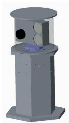
Abbildung 8: einfaches CAD-Model der LIDAR/RADAR-Sensorkombination
