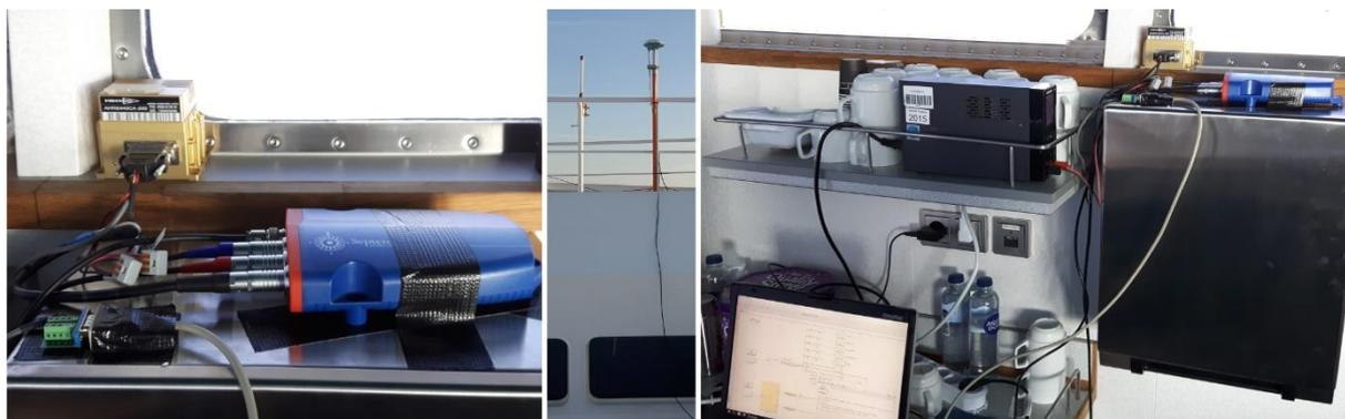
Abbildung 2: Messanordnung an Bord mit Crossbow AHRS440 und AsteRx3 (a), der GNSS-Antenne auf Deck (b) sowie Netzteil/ Laptop
